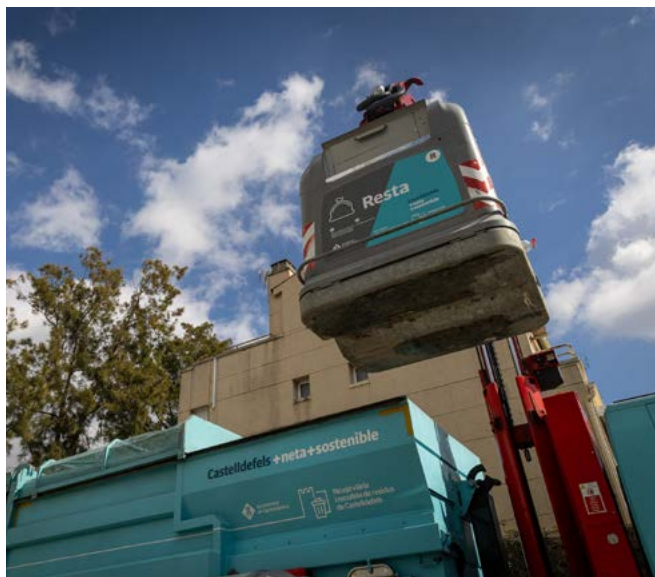
Camió amb sistema de recollida de càrrega bilateral automatitzada i operada des de cabina (CBL)
