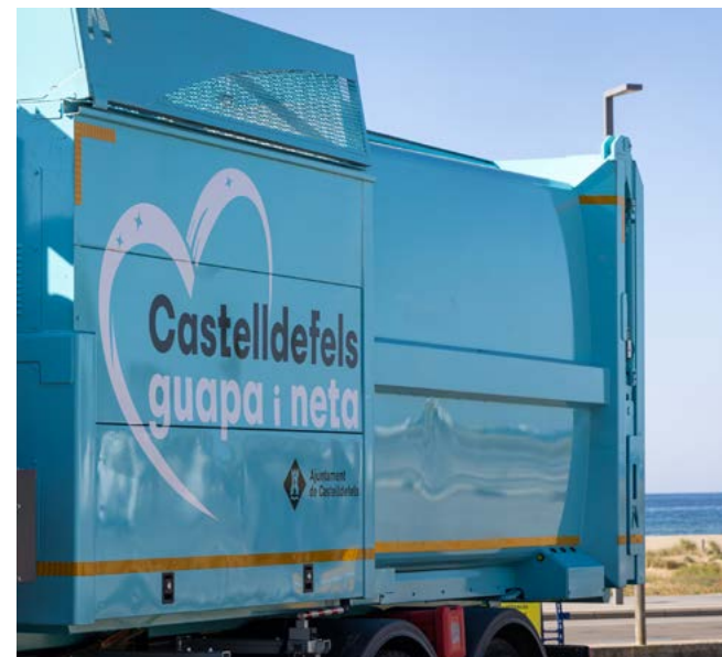
Camión bicompartimentat de recollida de la fracció resta i orgànica (Porta a Porta grans generadors).
